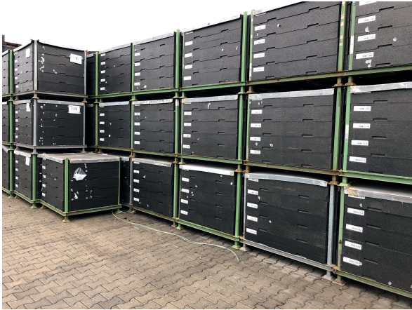
Bild 2. Die ausgemusterten Ladungsträger werden gesammelt, verdichtet und anschließend zu Granulat verarbeitet (© JSP)
