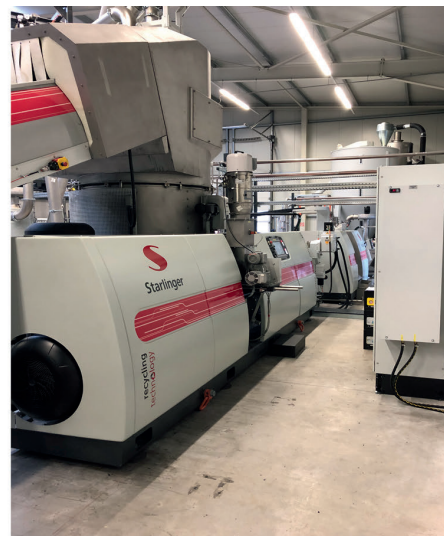
Bild 3. Im hessischen Eschwege werden die gesammelten Ladeträger zu EPP-Regranulat verarbeitet und anschließend im Labor auf Schlüsselkriterien untersucht (© GID)
