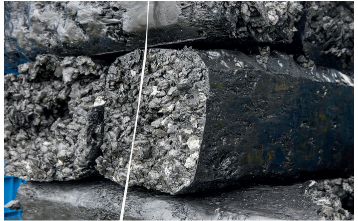
Bild 2. Die ausgemusterten Ladungsträger werden gesammelt, verdichtet und anschließend zu Granulat verarbeitet (© JSP)
