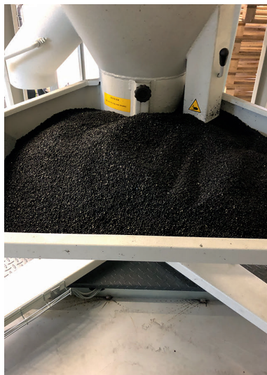
Bild 3. Im hessischen Eschwege werden die gesammelten Ladeträger zu EPP-Regranulat verarbeitet und anschließend im Labor auf Schlüsselkriterien untersucht (© GID)
